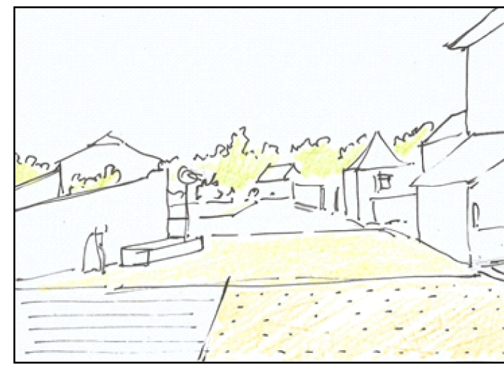
Croisement traversée du lotissement des Bruyères vue depuis l'ouest. Mise en place d'un plateau mettant en valeur la fontaine et réduisant la vitesse de circulation.
