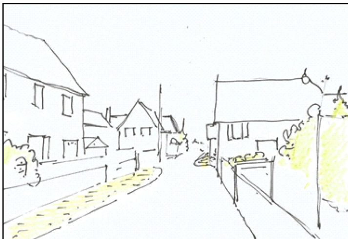
Route de Sermérieu vue depuis le sud. Mise en place d'une circulation piétonne alternant les côté de la rue et créant un effet de chicane.
