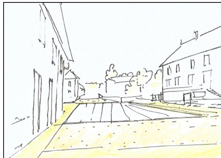
Place de la mairie, vue depuis le nord. Mise en place de passages piétons. Traitement de la surface de la chaussée pour réduire l'avitesse de circulation.
