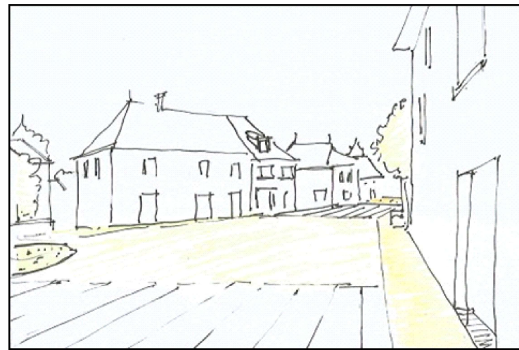
Place de la mairie, vue depuis le sud. Mise en place de passages piétons. Traitement de la surface de la chaussée pour réduire l'avitesse de circulation.
