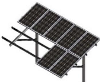
Les ancrages utilisés sont des ancrages de profondeur composés de pieux enfoncés dans le sol (l'espacement et la profondeur des pieux dépend des études géotechniques qui restent à réaliser). Le schéma à gauche illustre cette technique.
